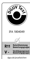
CleanGrip besteht den DGUV-Test und erhält das Prüfzeichen für die Rutschhemmung R11. Im Balkendiagramm werden die Rutschhemmungsempfehlungen der BAuA pro genanntem Gefährdungsbereich der ASR A1.5/1,2 aufgezeigt. Die meistempfohlene Rutschhemmklasse ist R11.
